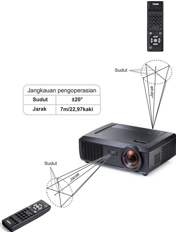
**CATATAN:** Jangkauan pengoperasian yang sebenarnya dapat sedikit berbeda dari diagram. Daya baterai yang lemah juga akan membuat remote control tidak dapat mengoperasikan proyektor dengan benar.
