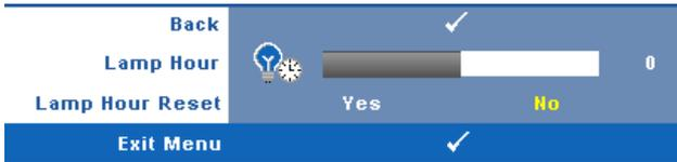
**LAMP HOUR (JAM LAMPU)**—Menampilkan jam pengoperasian sejak pengaturan ulang timer lampu terakhir.
